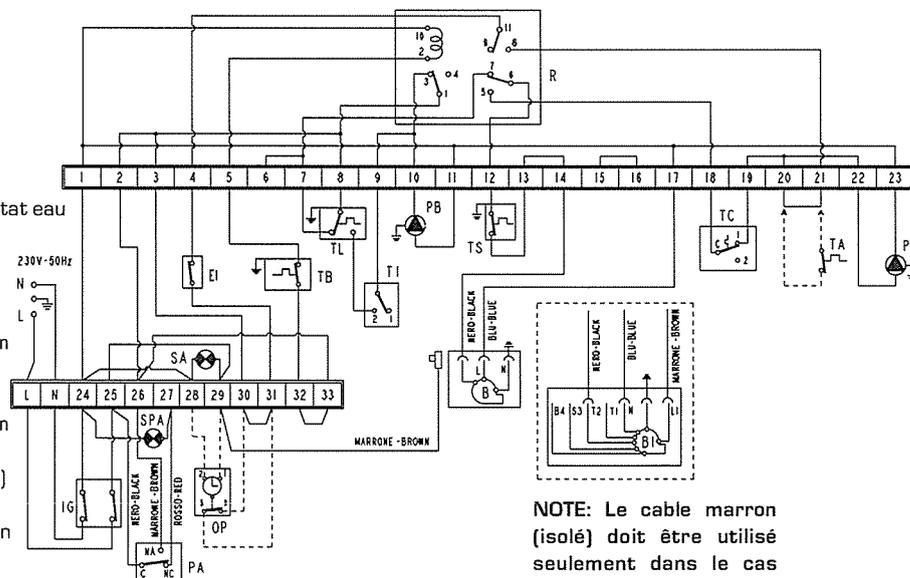
**NOTE: Le câble marron (isolé) doit être utilisé seulement dans le cas d'un brûleur du type à alimentation permanente (type B1).**
