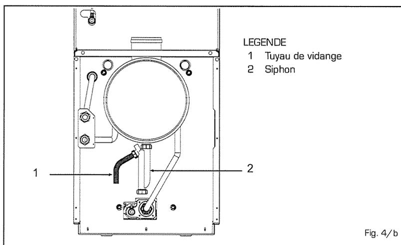
nécessaire de relier l'égouttoir siphonné à l'évacuation vers le réseau civil par un tuyau (ø 25) présentant une pente de 5 mm par mètre.
